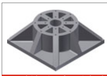
Im Vergleich: Die Aufspanntische oben und unten: links aus Metall, rechts aus faserverstärktem Kunststoff. Die Massereduktion erlaubt die Erhöhung der Prüffrequenz.
