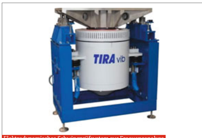
Elektrodynamisches Schwingprüfsystem zur Frequenzanalyse in vertikaler Richtung
